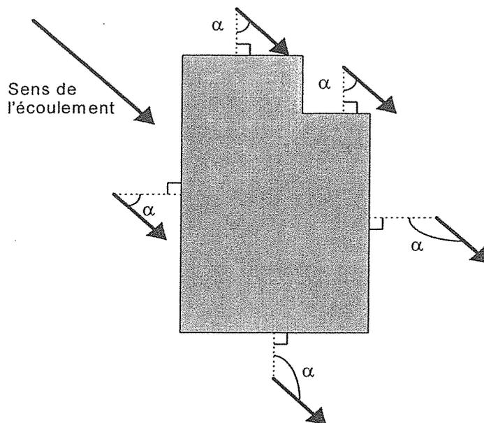
Toute disposition architecturale particulière ne s'inscrivant pas dans ce schéma de principe devra être traitée dans le sens de la plus grande sécurité.
