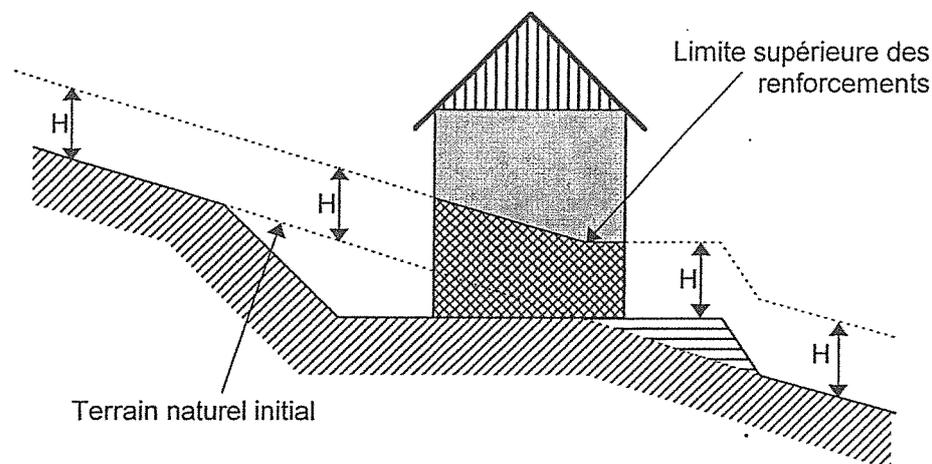
Toute disposition architecturale particulière ne s'inscrivant pas dans ce schéma de principe devra être traitée dans le sens de la plus grande sécurité.
